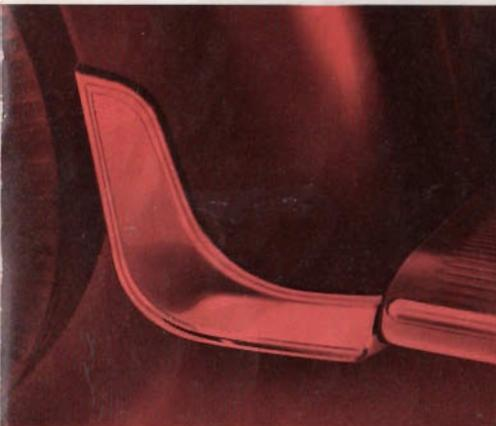
**No. 932** Steinschlagblech für hintere Kotflügel, aus Leichtmetallguss, hochglanzpoliert – Sabots pour ailes arrière, en fonte métal léger poli – per Paar – la paire
