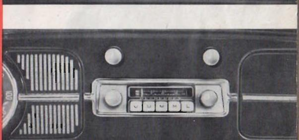
**No. 823** Autoradio Blaupunkt «Köln» mit 3 Wellenbereichen: UKW, Mittel- und Langwellen. Durch Selectomat-Stationsfinder selbst-tätige und vollautomatische Ein-stellung der Sender – Auto-radio Blaupunkt, modèle «Köln», 3 gammes d'ondes: ultra-courtes, moyennes et longues, sélection automatique des émetteurs grâce au sélectomat Fr. 668.—
